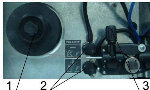
3. Убедиться в том, что прижимной ролик (рис. 2 поз. 3) зажат не слишком сильно. Чрезмерный прижим приведет к преждевременному износу прижимного ролика.
